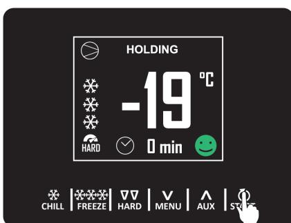
Une fois terminé le cycle de refroidissement rapide/surgélation, température sonde à coeur atteinte ou fin du temps, le buzzer sonne et commence la phase de conservation; si le cycle de température ne se termine pas dans le temps imparti, l'anomalie sera signalée par la présence d'un message d'alarme.
