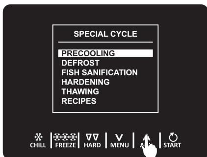
Il s'agit d'un cycle de réfrigération d'une durée infinie qui peut précéder tous les cycles de fonctionnement. Il peut également être utilisé comme cycle de réfrigération d'une durée infinie.
