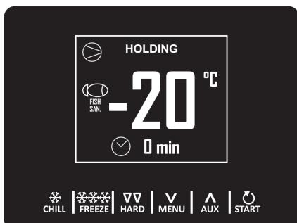
Pendant l'exécution d'un assainissement, l'appareil affichera toujours la température de la cellule et, en fonction de la phase en cours, la température de fin refroidissement rapide ou la durée du maintien.
