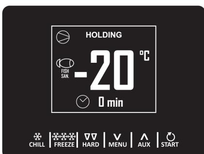
Durante la ejecución de un saneamiento, el dispositivo siempre mostrará la temperatura de la celda y, dependiendo de la fase en curso, la temperatura al final del abatimiento o la duración del mantenimiento.
