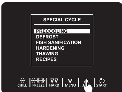
Es un ciclo de refrigeración de duración infinita que puede preceder a todos los ciclos de funcionamiento.
